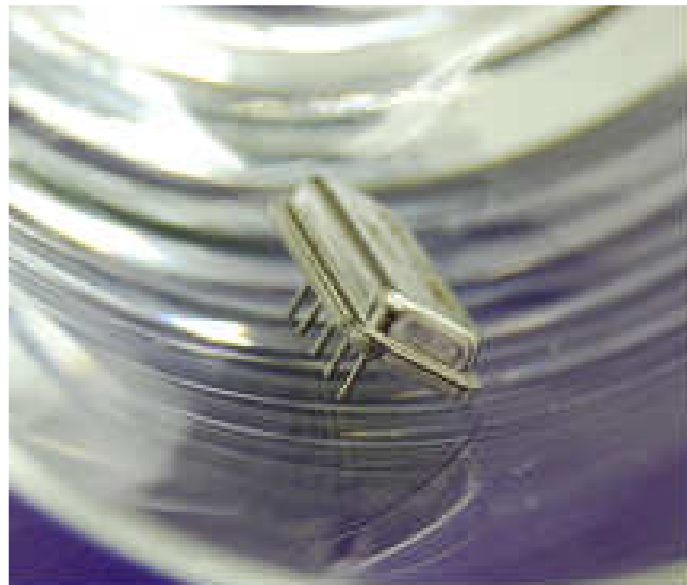
Рис. 2 STW резонатор A474-1000M1
